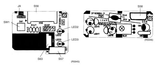
PCB(4): Humidity sensor PCB
